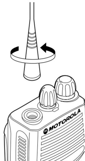
Dévissez l'antenne en la faisant tourner dans le sens contraire des aiguilles d'une montre.
