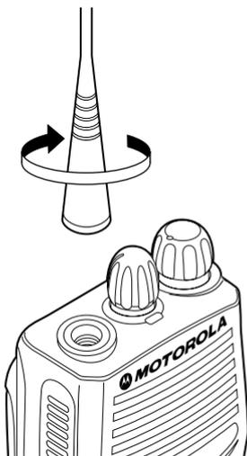
Visez l'antenne en la faisant tourner dans le sens des aiguilles d'une montre.
